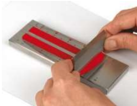
الشكل رقم (5): جهاز ( هيجمان ) لقياس نعومة الطحن
